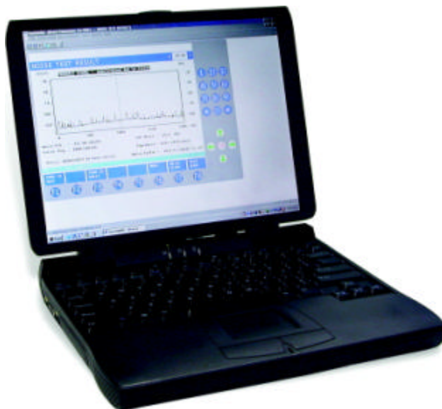
利用 PC 及 Visi-SHARK 軟件控制 CableSHARK
